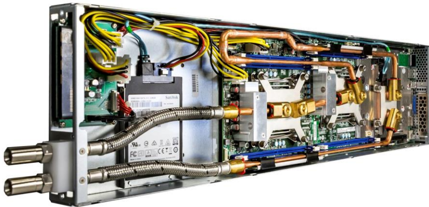
Abbildung 1: 100% wassergekühltes Blade der Firma Megware
